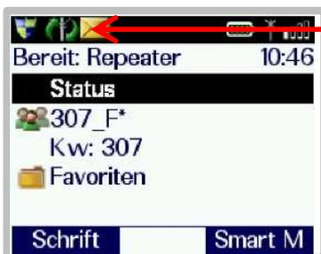
Der Repeaterbetrieb wird im Display oben rechts angezeigt.
