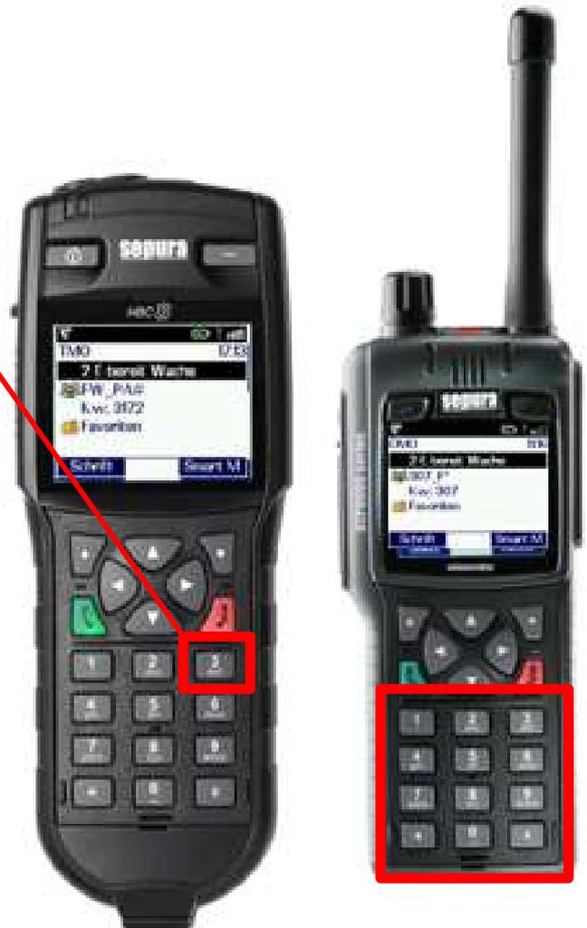
Zum auslösen einer Statusmeldungen, ist die entsprechenden Taste für ca. 2 Sekunden zu drücken.
