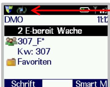
Befindet sich das Endgerät im Sendebereich eines Repeaters wird dies durch ein zusätzliches Symbol für den Betriebszustand angezeigt
